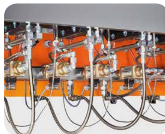
Aufgeräumtes Zylinderkühlkonzept mit wartungsfreien High-End-Ventilen
