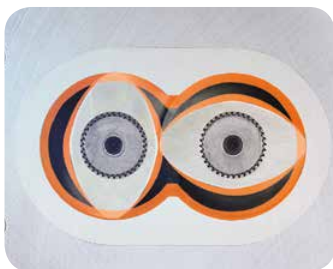
Erhöhtes Schneckenvolumen bei gleichem Achsabstand wie die ZSE HP-Baureihe (orange = Volumenzuwachs)
